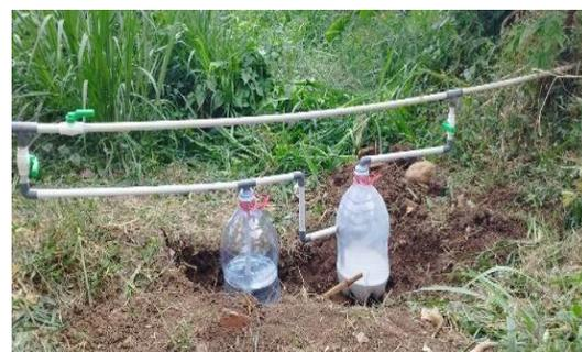
**Gambar 3.** Tabung Water Trap dan Adsorber Pada Alat Biogas
