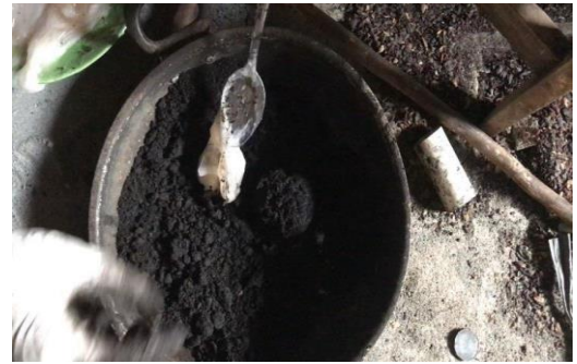
Gambar 6. Pencampuran kanji (perakat) ke dalam kulit kopi yang suda
