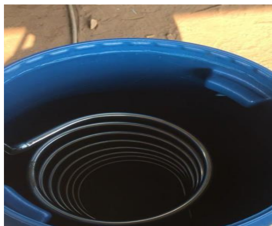
Gambar 2. Tampilan dalam tangki kondensor untuk merubah asap pembakaran menjadi asap cair
