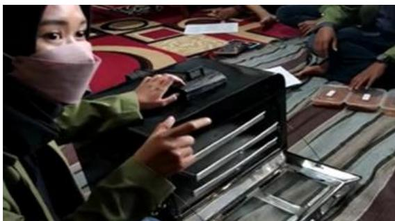
**Gambar 1. Alat pengering cabai modifikasi dengan pengatur suhu otomatis**
