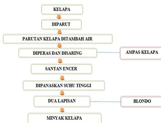
Gambar 1. Blok diagram pembuatan minyak kelapa murni dari buah kelapa
