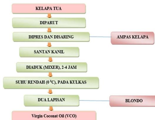
Gambar 2. Blok diagram pembuatan VCO dari buah kelapa
